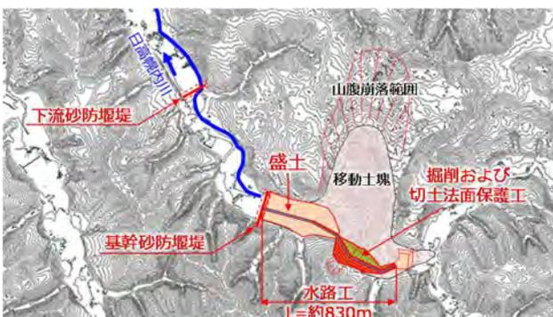
図-9 日高幌内川緊急対策工の概要
