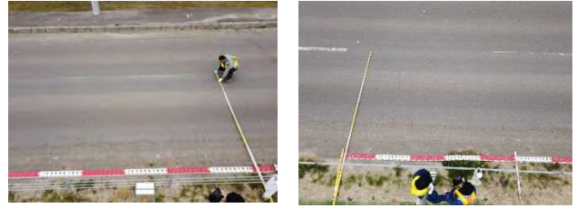
図-6 ジンバルカメラを使用した人力による撮影 1人目：スケール設置、撮影中に車が来た場合の対応 2人目：カメラ撮影(タブレット画面を見ながら調整して撮影) 3人目：カメラ持ち(スタッフの先端に取り付けたカメラを持ったまま脚立に乗ってカメラ位置を調整)
