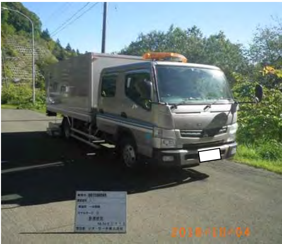
写真-2 路面下空洞探査車
