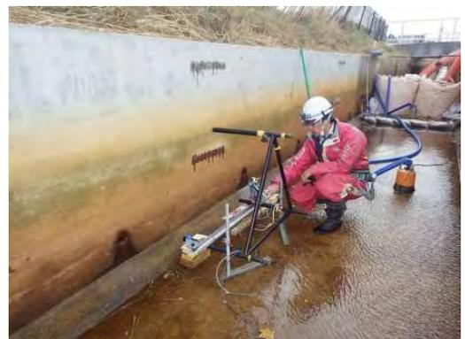
写真-4 摩耗量測定状況
