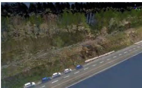
図-2 類型5: UAV搭載型LSにより取得した点群データ
