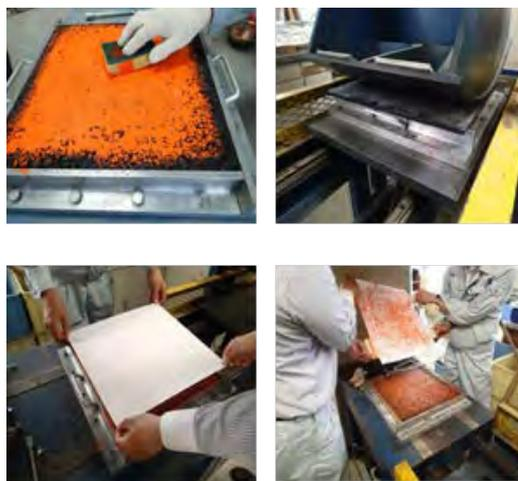
写真-2 供試体底面の転写状況
