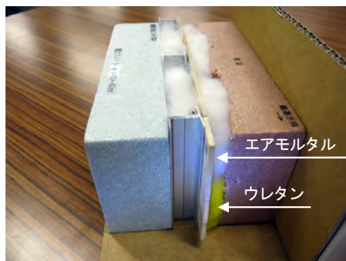
写真-16 断面②（注入後）
