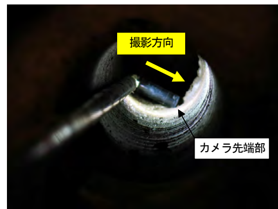
写真-10 コア孔CCD撮影状況
