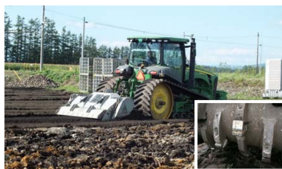
写真-2 ストーンクラッシャーによる石礫破碎状況 (右下の写真はクラッシャーの金属歯)
