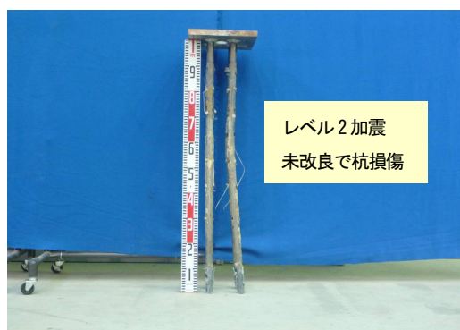
写真-2 レベル 2 加振による杭の変形 (ケース 1 未改良)
