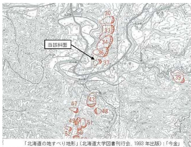
図-5 後志利別川上流部の地すべり地形
