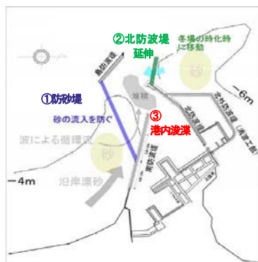
図-6 防砂堤新設・北防波堤延伸計画
