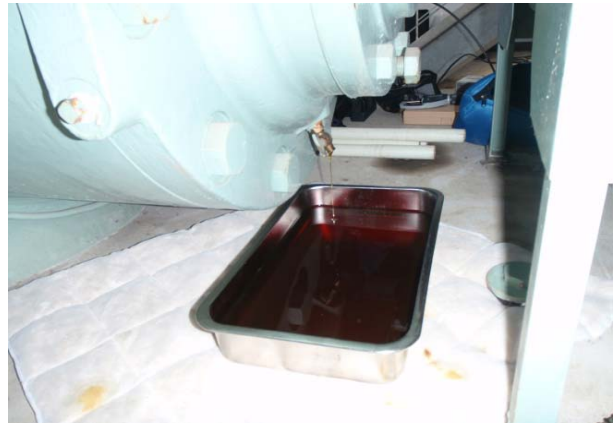
写真-8 外部軸受潤滑油採取状況
