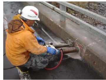
写真-3 透過法による測定を行うための試料の採取の実況
