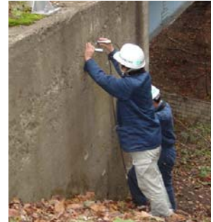
写真-2 構造物での表面走査法による測定の実況
