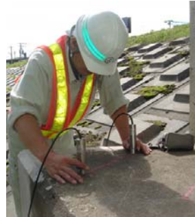
写真-2 構造物での表面走査法による測定の実況
