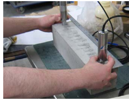
写真-1 表面走査法による測定状況
