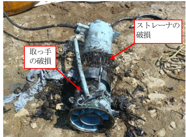
写真-6 破損したポンプ
