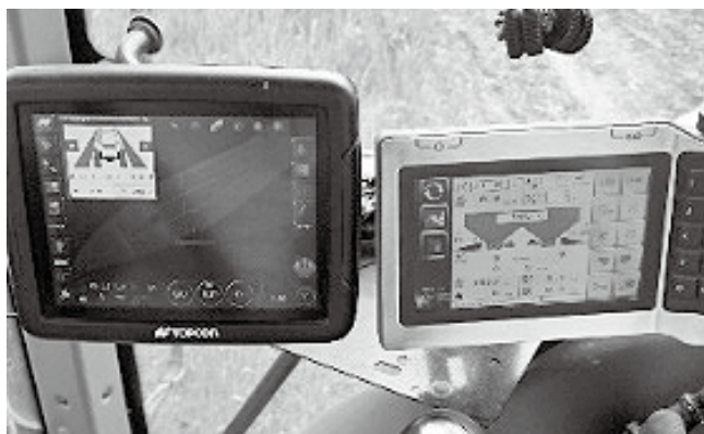
左のモニターは、施肥した場所が分かるGNSSとセンサーのデータ。 右のモニターは、タンク内の肥料の量と調整ができる。
