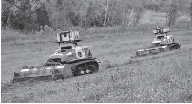
堤防除草の自動化実証試験
