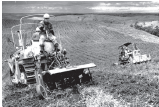
ブルドーザによる地拵作業
