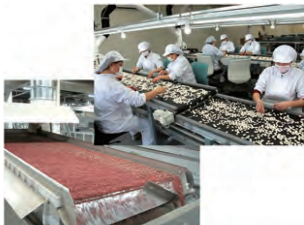
写真-2 上) 人手による手選別 下) 比重選別機による選別
