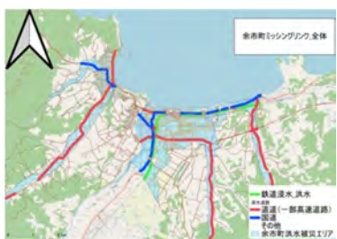
図 19-a 余市町洪水による道路被害 (著者作成)
