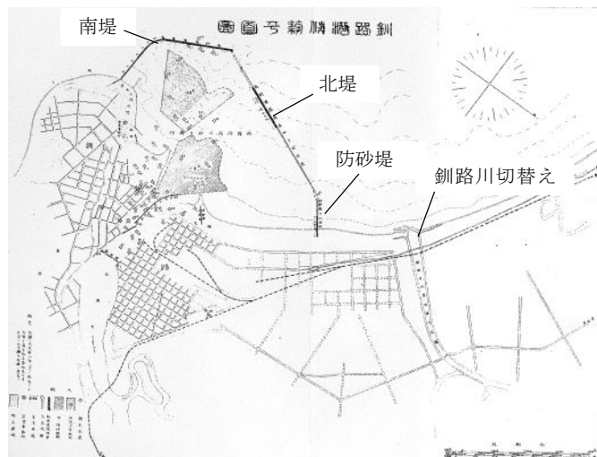
図 4.7 第一期拓殖計画における釧路港修築平面図
