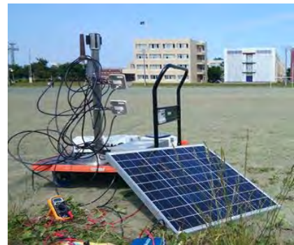
図 15 基地局と太陽光発電パネル
