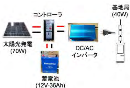
図 30 電力システムの構成図
