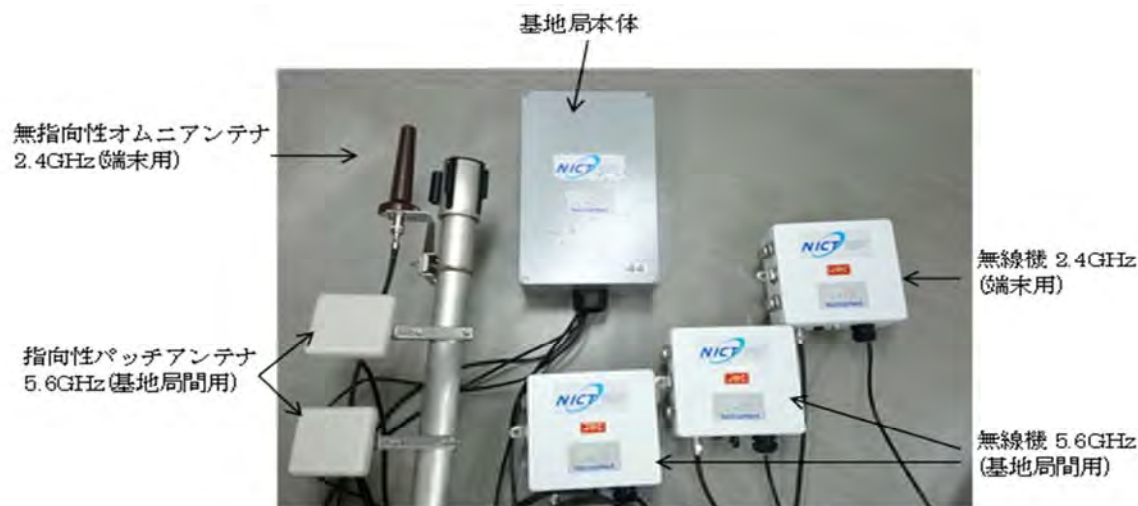
図 13 基地局の機器構成と接続
