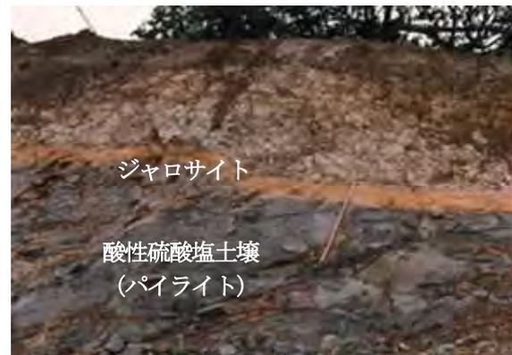
図-1 酸性硫酸塩土壌開削面（留萌管内新第三紀勇知層）
