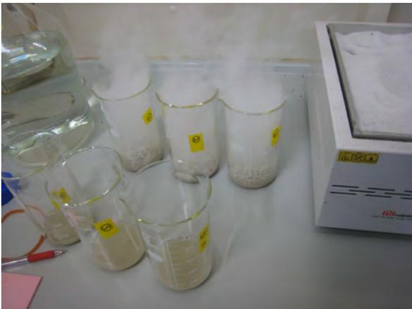
図-3 過酸化水素水 (H<sub>2</sub>O<sub>2</sub> 30%) による強制酸化
