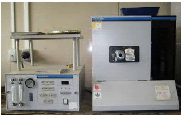
図-4 硫黄分析装置による硫黄含有量の分析
