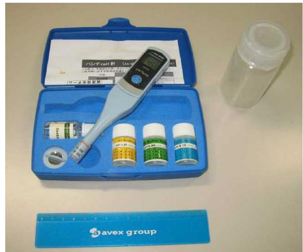
図-5 簡易判定法に使用する携帯式pH計とポリ瓶
