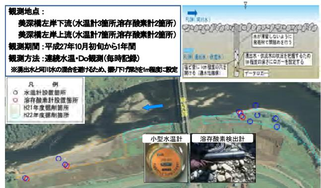
写真-5 H27水温・溶存酸素計の設置概要
