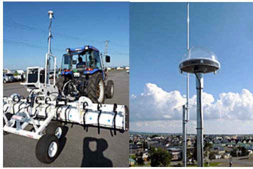
写真-3 GPS均平機と役場屋上に設置されたGPS基地局
