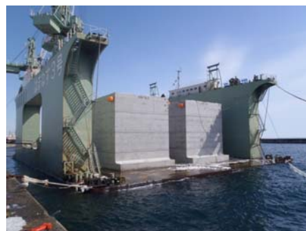
写真－1 ケーソン製作用台船
