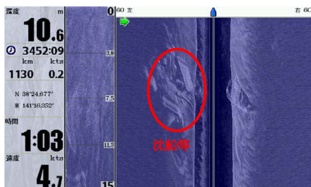
図-10 沈下物状況画像①（石巻）
