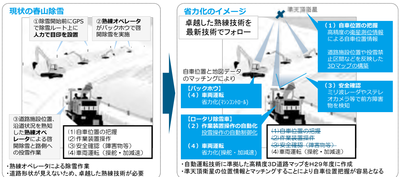
図ー2 知床峠除雪作業の現状と省力化後のイメージ
