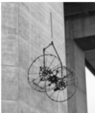
二輪型マルチコプタによる橋梁点検
