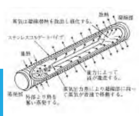
図2 ヒートパイプの作動原理と構造
